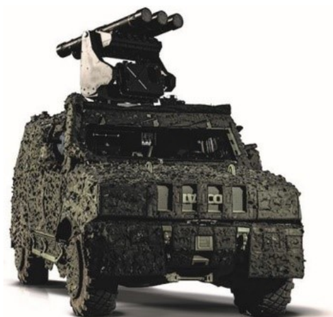
Figura 13: Lançador RBS70 RWS do Sistema Saab MSHORAD (plataforma Iveco LMV).
