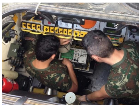
Figura 3: Estudo de sinais eletrônicos com engenheiros na VBC AAe Gepard.
