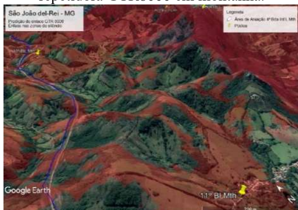
Figura 2 – sistema de predição de enlace da repetidora GTR8000 em montanha.
