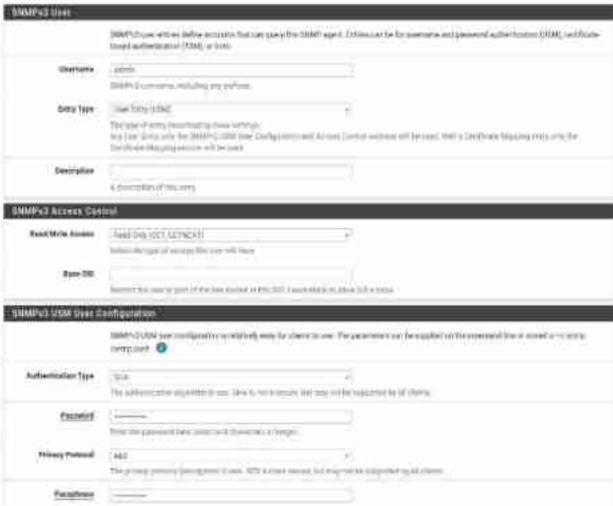
Figura 11: Configuração do SNMPv3 no pfSense
