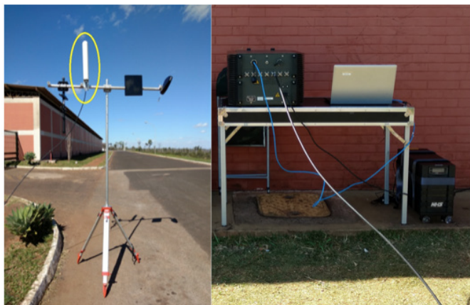
FIGURA 10 - Detalhe antena omnidirecional interferidor SCE 0100 – IACIT e interferidor SCE 0100 – IACIT.
