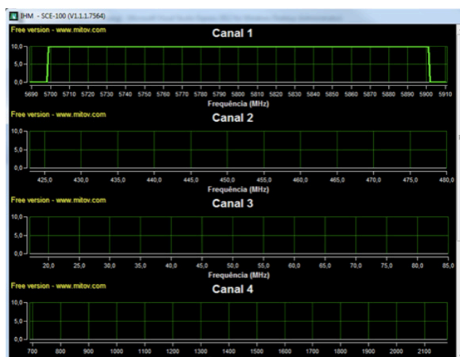
FIGURA 6 - Visualização da realização de uma interferência no Canal 1 (IACIT, 2016).
