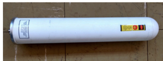
FIGURA 7 - (a) Antena omnidirecional para a frequência de 2,4 GHz (Canal 5) e (b) Antena omnidirecional para a frequência de 5,8 GHz (Canal 6).
