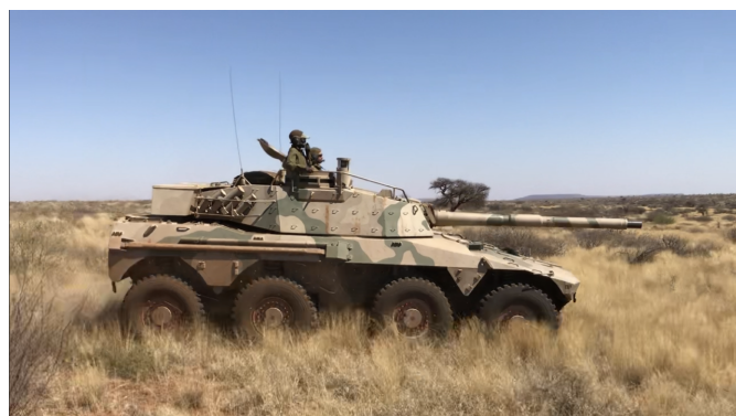
FIGURA 2 Rooikat - Viatura do Regimento de Cavalaria Mec com canhão 76mm
