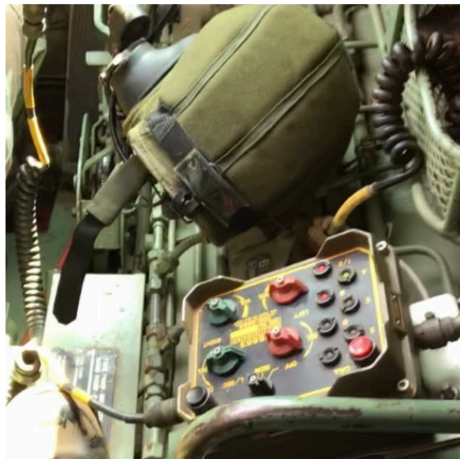
FIGURA 4 Capacete com fone de ouvido e caixa de controle das viaturas.
