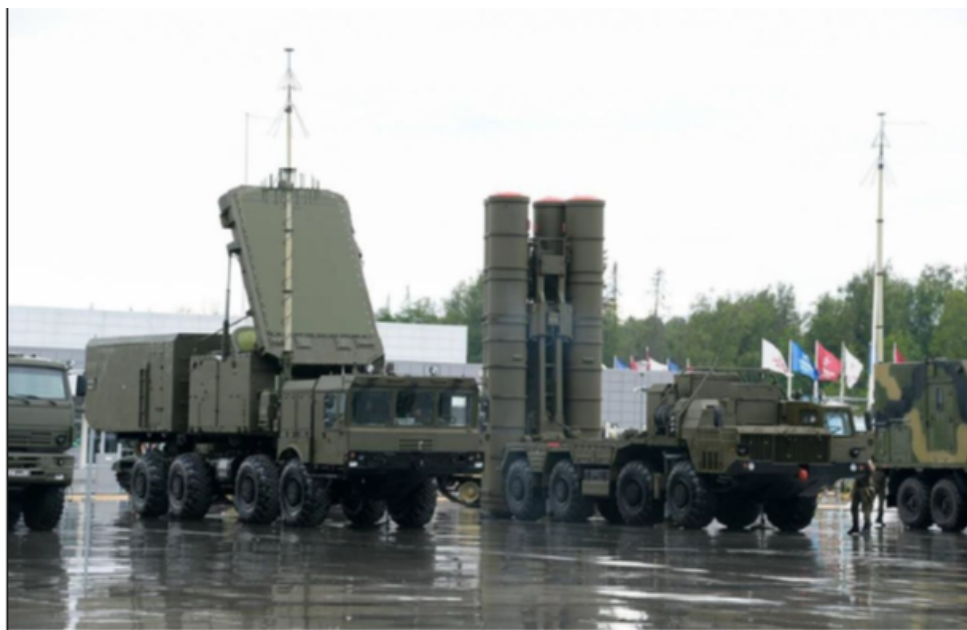
Figura 3 – Sistema S-400 (Radar de engajamento à esquerda, e veículo transportador-montador-lançador à direita).
