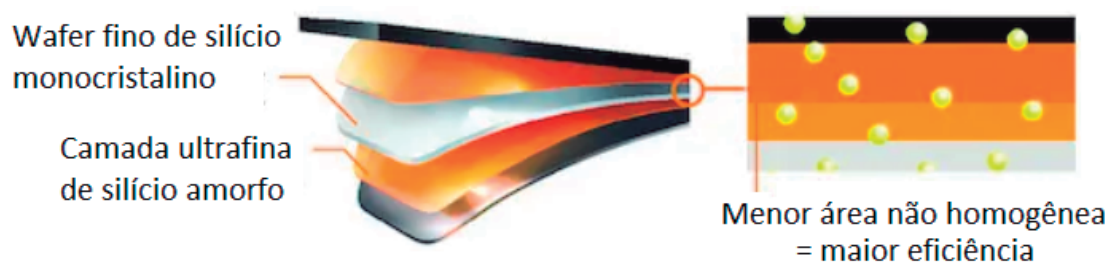
Figura 7 Estrutura de wafers de silício de heterojunção
