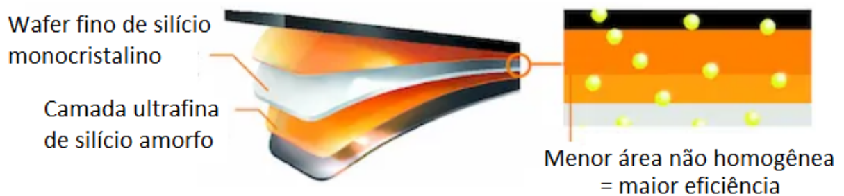
Figura 7 Estrutura de wafers de silício de heterojunção
