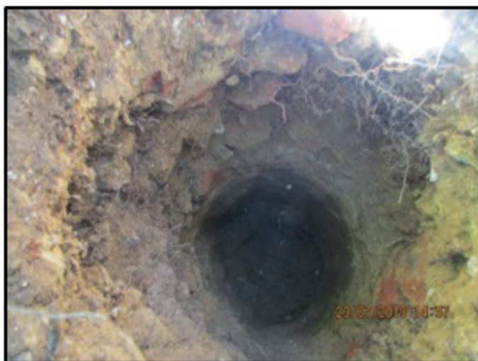
Figura 2 – Estratigrafia do ponto de tradagem L15/P2 com grande concentração de material construtivo – área B – morro Cara de Cão – RJ
