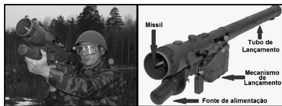
Figura 3 – Míssil Igla-S Fonte: www.kbm.ru (com anotações do autor)
