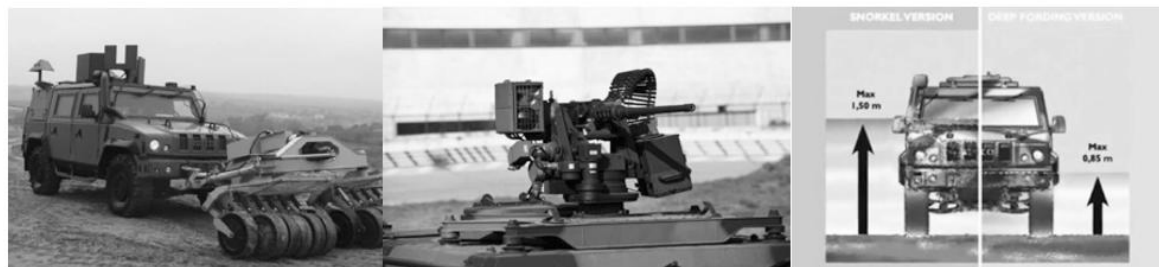
Figura 5 – Adaptação de acessórios conforme o emprego tático Fonte: Militarypedia, 8 ANALISIDIFESA 9 e Iveco Defence Vehicles
