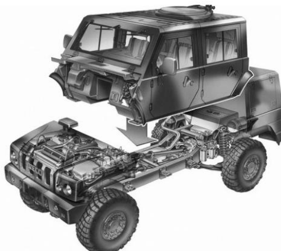
Figura 3 – Proteção blindada, concepção modular da carroceria e robustez mecânica Fonte: Iveco Defence Vehicles e alVolante.it 6
