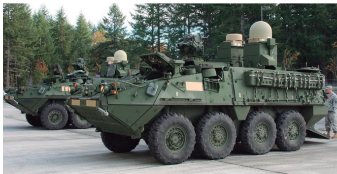
Figura 1 – Protótipo do Blindado STRYKER Posto de Comando. Destaque para o domo branco, que é uma antena satelital para operações, inclusive em movimento
