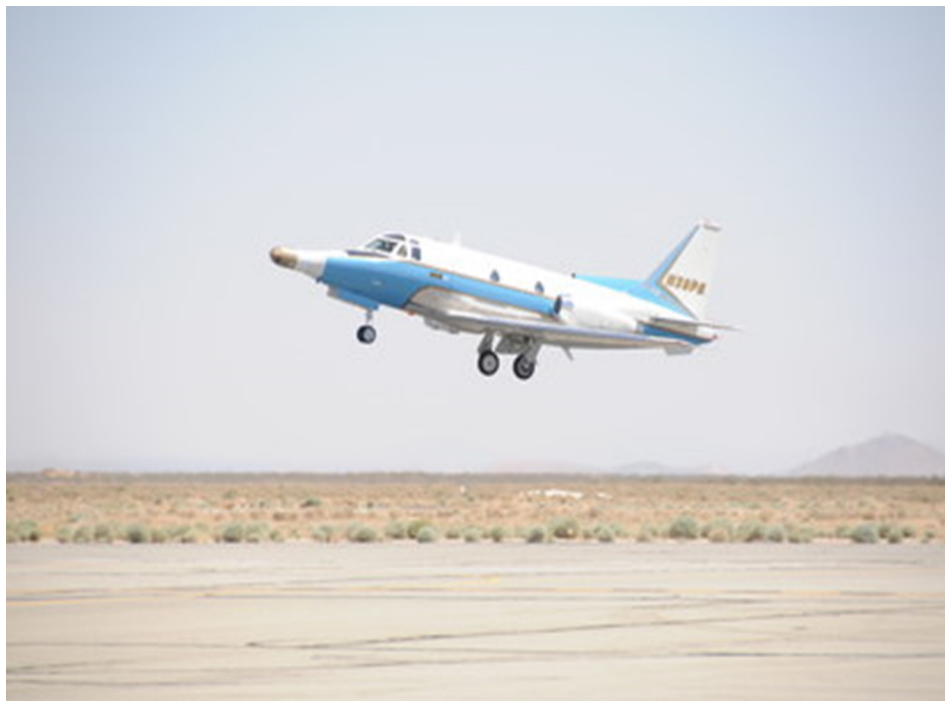
Figura 4 – Ensaio em voo cativo (2015) do seeker multimodo desenvolvido pela empresa norte-americana Raytheon. O protótipo do seeker foi instalado em um nariz de Tomahawk fixado à frente de uma aeronave T-39
