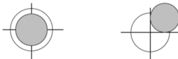
Figura 6 – El círculo a la izquierda representa alta exactitud y baja precisión. El círculo a la derecha indica baja exactitud y baja precisión.
