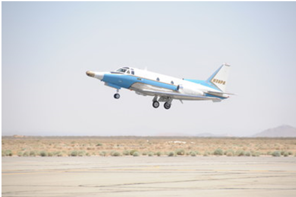
Figura 4 – Prueba de vuelo cautivo (2015) del seeker multimodo desarrollado por la empresa norteamericana Raytheon. El prototipo de seeker se instaló en un morro Tomahawk sujetado al frente de una aeronave T-39.
