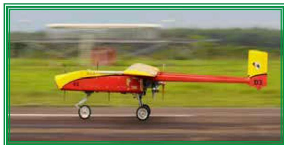
Figura 3 – VANT Acauã realizando pouso automático
