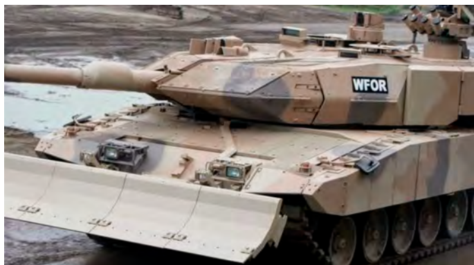
Figura 02: Modelo de uma Lâmina Bulldozer instalada em um carro de combate Fonte: https://www.warfareblog.com.br/2014/12/krauss-maffei-wegman-leopard-2a7-mitica.html
