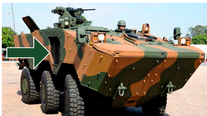
Figura 07: Sistema de arrefecimento (conjunto de radiadores) voltado para a lateral do carro Fonte: Arquivo pessoal do autor
