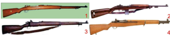
Figura 02: 1. Fuzil Mauser "brasileiro" Modelo 1908, em calibre 7x57mm 2. Carabina M-1 da FEB (Cal .30) 3. Fuzil Springfield da FEB (Cal 7,62mm) 4. Fuzil Garand da FEB (Cal 7,62mm)
