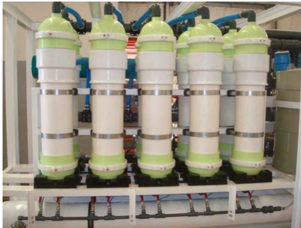
Figura 22 - Membranas (filtros) UFOR
