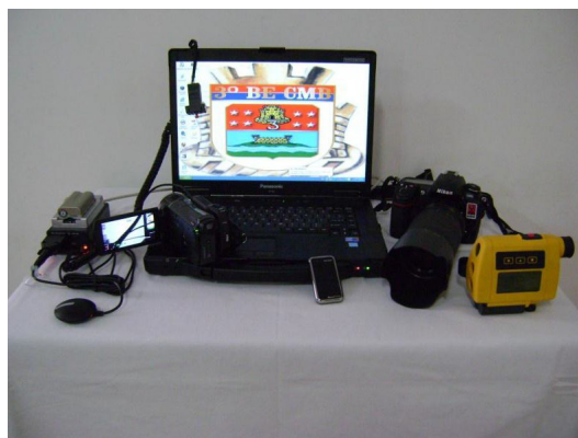
Foto 10 – Foto da filmadora conectada ao GPS e ao computador, a câmera conectada ao receptor Blu2Can e ao GPS GlobalSat e do telêmetro laser;
