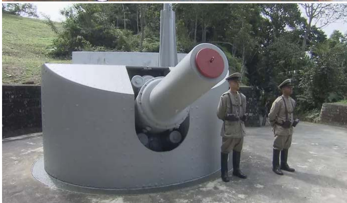
Obuseiro Krupp modelo 1942, calibre 280mm. Canhão de tiro curvo, que pesava 10 ton e o seu projétil 354 Kg. O alcance era de 9.000m.
