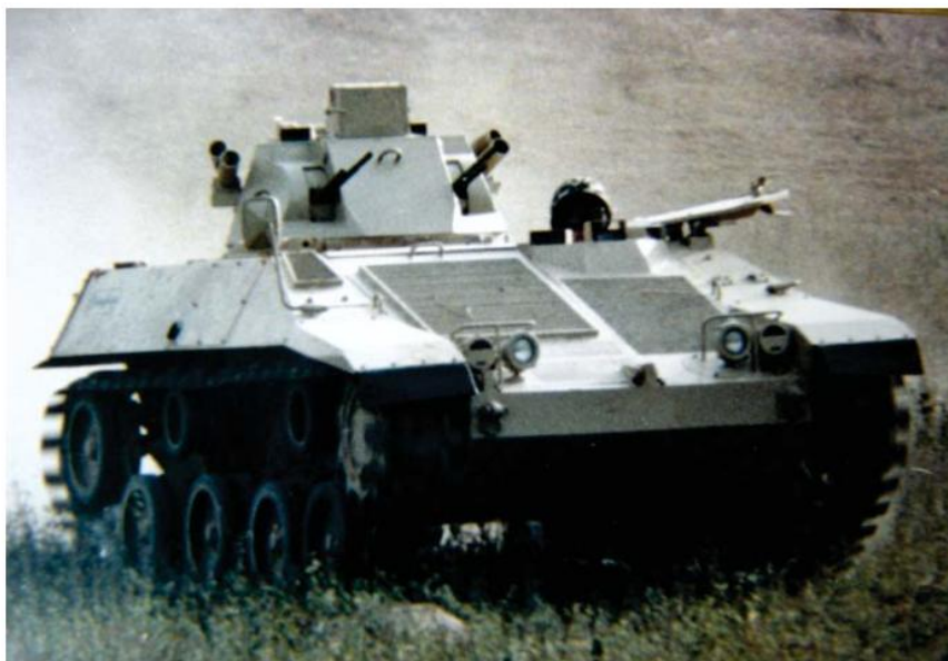
EE-T4 Ogum com torreta antiaérea, armado com metralhadoras 7,62mm, desenvolvido para o Iraque (Foto: Coleção autor)
