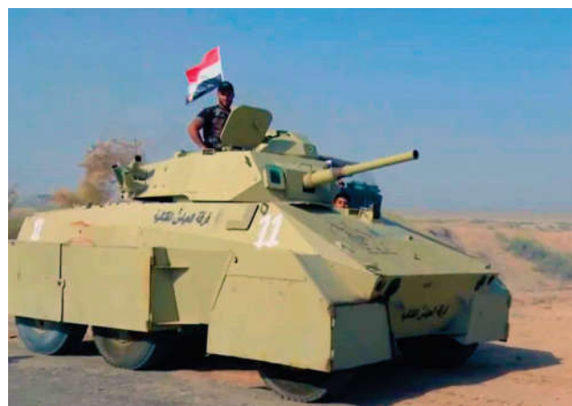
EE-9-Cascavel M-4 da Brigada 26 Al-Abbas, utilizando, no lugar do canhão Engesa EC-90 de 90 mm, um canhão russo de 73mm modelo 2A28 Grom, oriundo de uma BMP-1 ou BMD-1, com saias laterais de proteção, operando na região de Mosul, Iraque, em 14 de agosto 2017. (Crédito da foto: Al Abbas Squad)
