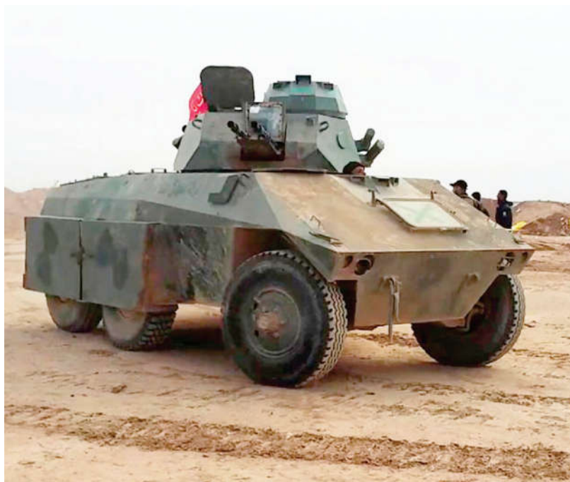
EE-9-Cascavel M4 da Brigada 26 Al Abbas (Iraque), utilizando saias laterais nas rodas traseiras, metralhadora dupla ZPU-2 de fabricação russa e calibre 14,5mm, no lugar do canhão Engesa EC-90 de 90mm, operando na área de Mosul, em 23 de janeiro de 2017. (Crédito da foto: Iman Al- Holy Shrine)
