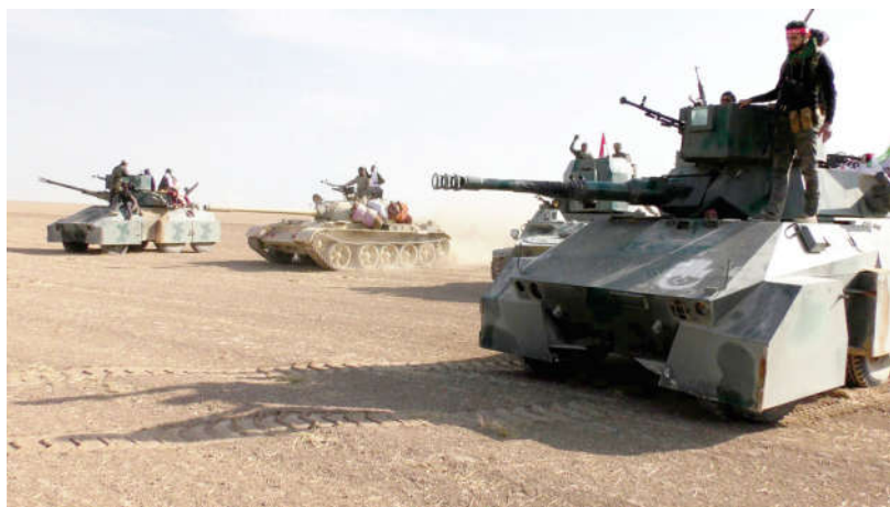
Dois EE-9-Cascavel M-4 da Brigada 26 Al-Abbas, utilizando saias laterais, uma grande torreta sobre a torre principal com metralhadora russa DShK (DUSHKA) calibre 12,7 mm, em operação de limpeza das aldeias ao sul de Mosul, em 13 de novembro de 2016. (Crédito da foto: War Media Team)
