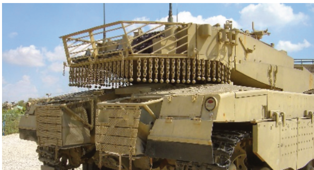
Figura 12: Merkava com blindagem “gaiola” do tipo corrente ( Chain Armor ). Fonte: Prime Port.
