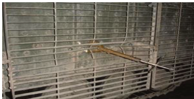
Figura 9: Blindagem do tipo gaiola atingida por RPG.
