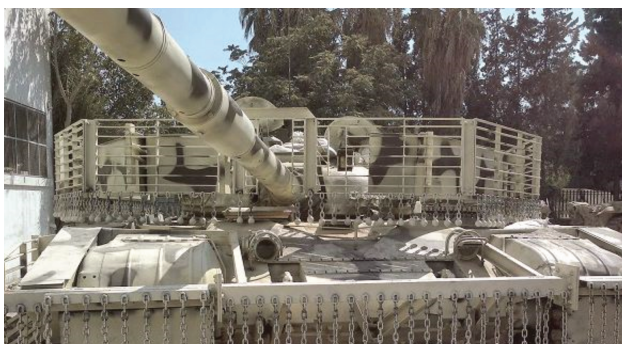
Figura 11: T-72 Sírio com blindagem “gaiola” do tipo corrente e barra. Fonte: South Front.
