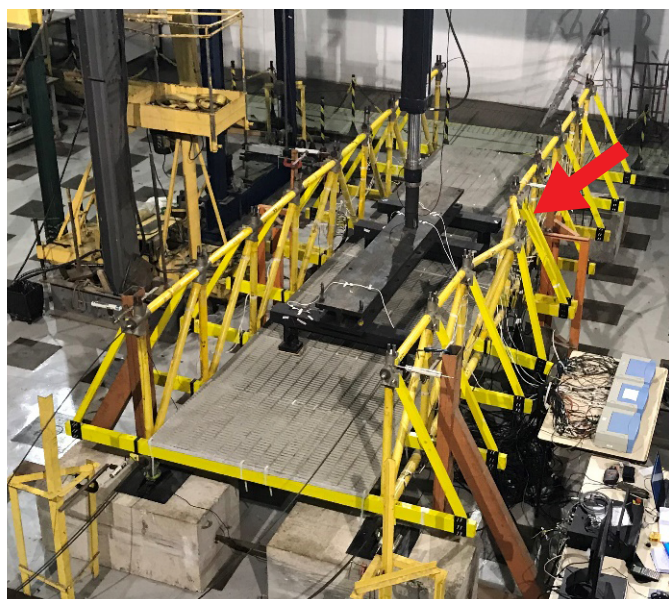
Fig. 39 – Vista superior da ruptura da ponte. Fonte: Acervo dos autores.
