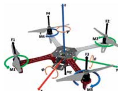
Fig. 2 – Forças ( F_i ) e momentos ( M_i ) do quadricóptero.
