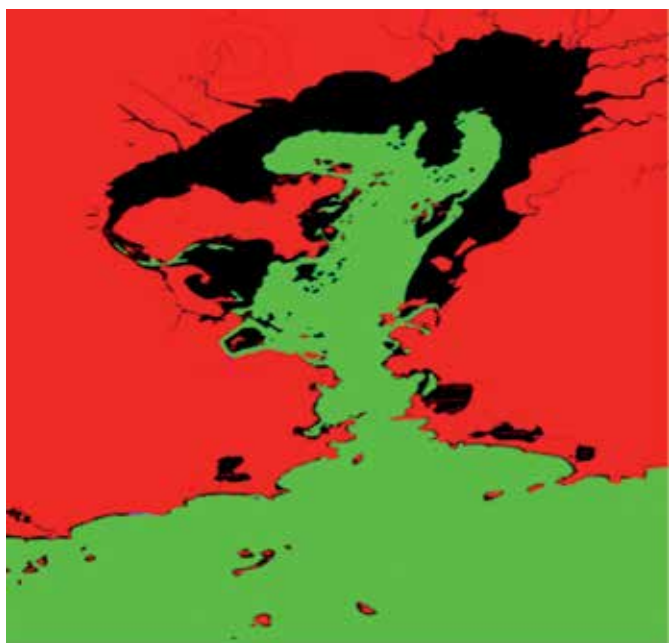
Fig. 4 - Imagem gerada para detectar pontos de trajetória sobre terra ou áreas não-navegáveis, representadas em vermelho, e áreas navegáveis, em verde.
