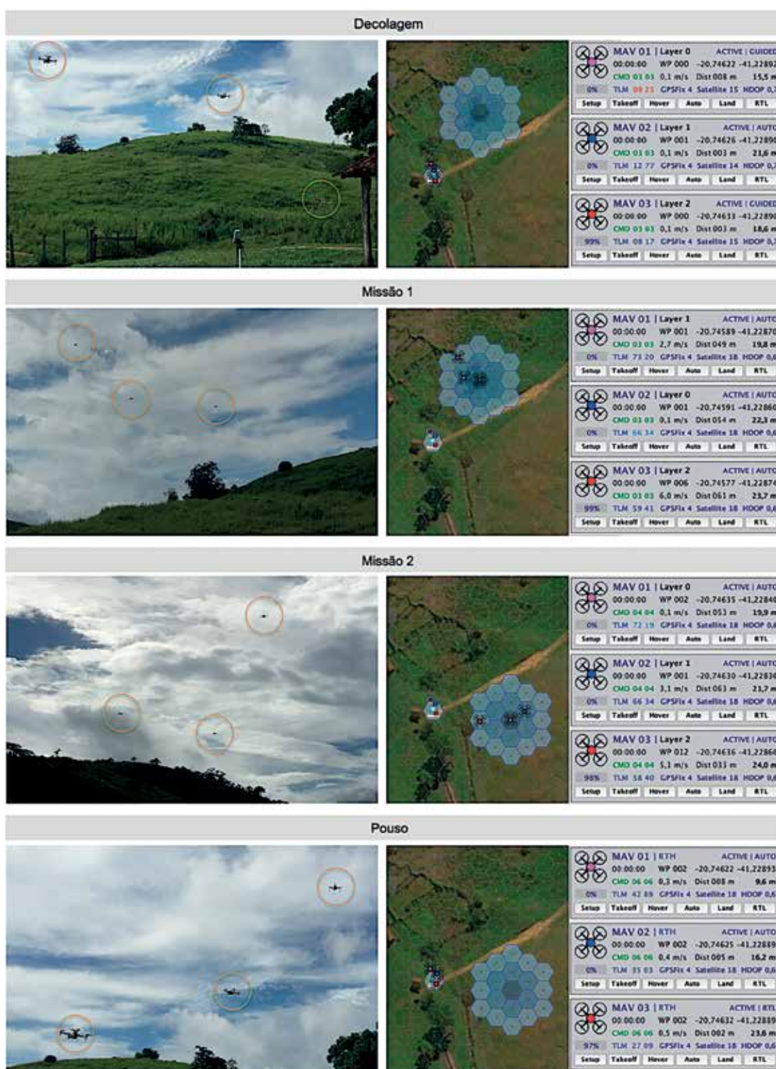
Fig. 12 – Quadros do vídeo do experimento em voo real e captura de tela da estação de controle em solo, com destaque para a posição das aeronaves no mapa e a telemetria em tempo real de cada ARP, para cada fase do voo. Decolagem: início da missão com decolagem automática. Missão 1: ocupação da primeira área de interesse. Missão 2: realocação da frota de aeronaves (após solicitação do operador) para ocupação da segunda área de interesse. Pouso: após solicitação do operador para o término da missão, as aeronaves retornam para o ponto de decolagem e pousam automaticamente.
