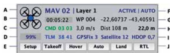
Fig. 7 – Painel de telemetria em tempo real para cada ARP.
