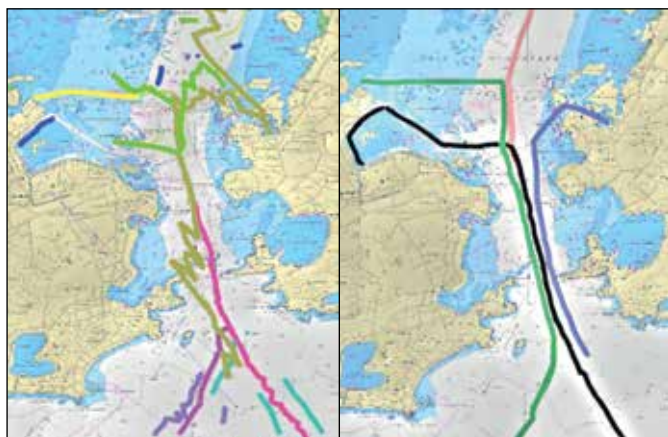
Fig. 7 - Trajetórias geradas para navios Offshore. À esquerda antes do pós processamento e à direita após o pós-processamento.
