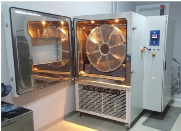
Fig. 14 - Equipamento Tumbler utilizado na avaliação de coletes balísticos pela NIJ 0101.06.
