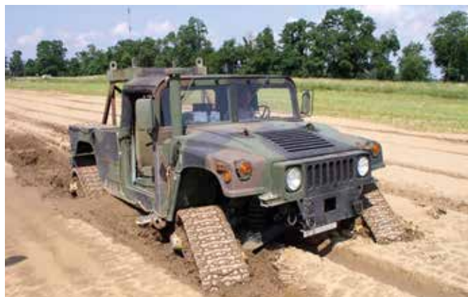
Fig. 8 – Exemplo de teste de trafegabilidade sendo realizado em pistas preparadas artificialmente. Fonte: [13].
