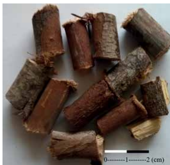
Fig. 7 – Galho de eucalipto picado empregado nos testes de gaseificação. Fonte: Acervo dos autores.
