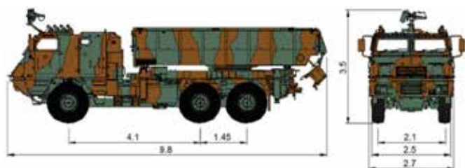
Fig. 35 – Dimensões da viatura ASTROS, em metros. Fonte: [20].
