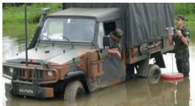
Viatura Marruá-teste em local de solo com textura fina.
