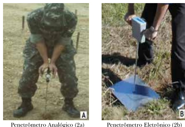
Fig. 2 – Exemplos de penetrômetros de cone. Fonte: [2]
