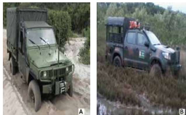
Fig. 15 – Viatura Marruá em teste de trafegabilidade em solo arenoso típico de região litorânea (A) e Viatura Hilux em solo típico de mangue (B). Fonte: [2]
