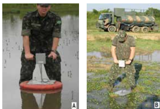
Teste de IC com penetrômetro de cone eletrônico
