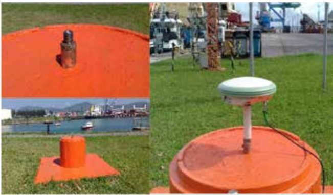
Fig. 3 – DCF implantado em um marco geodésico.
