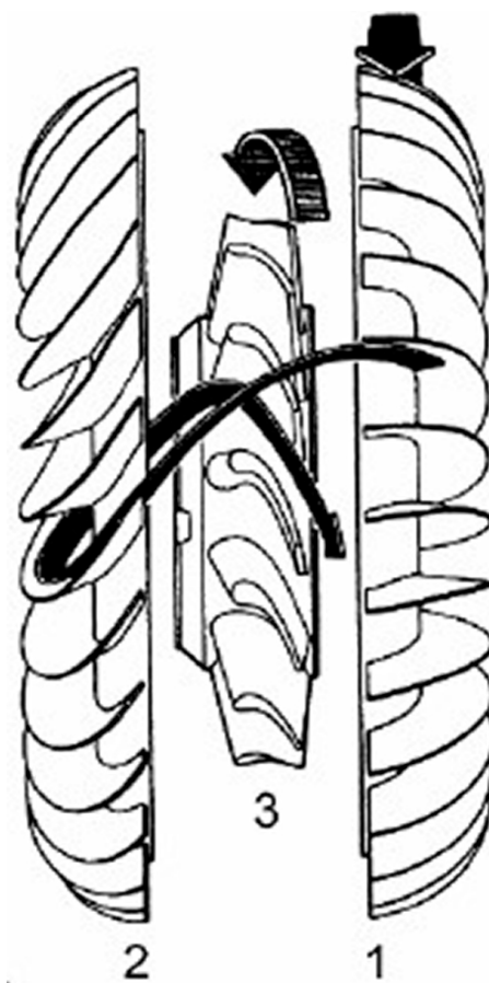
Fig. 3 – Esquema de um Conversor de Torque, com o fluxo de potência mostrado. 1:Bomba; 2:Turbina; 3:Estator [2].
