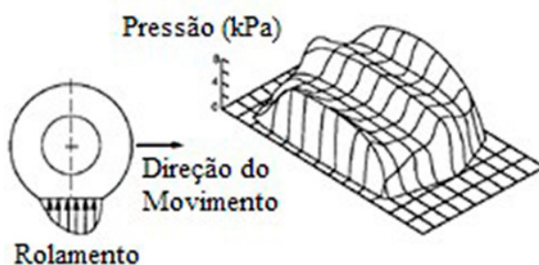
Fig. 9 – Distribuição de pressão no pneu [10].
