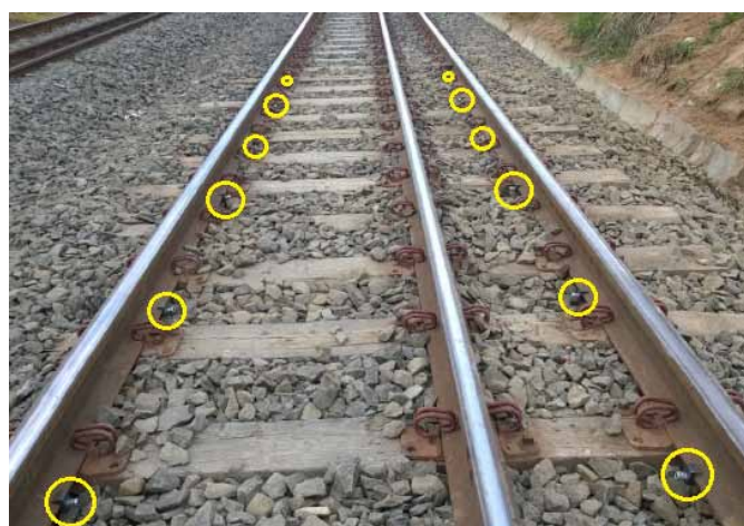
Fig. 6 - Foto dos sensores instalados na via permanente. Fonte: [12], modificado pelo autor.
