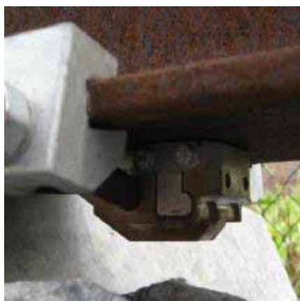
Fig. 11 – Sensor de fibra ótica instalado sob o trilho. Fonte: [15].
