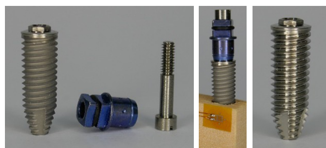
Figuras 2 - a) Implante Easy Grip 5x15mm com a superfície Porous; b) Implante Easy Grip instalado no corpo de prova; c) Implante usinado (Master Screw)
