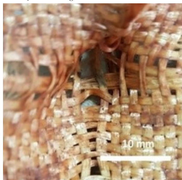
Figura 3 - Amostra com hematita a 7% após o teste de absorção de energia.
