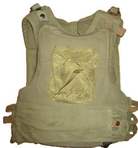
Fig. 4 - Coletes balísticos com insertos de materiais cerâmicos utilizados pelos americanos na Guerra do Vietnã.
