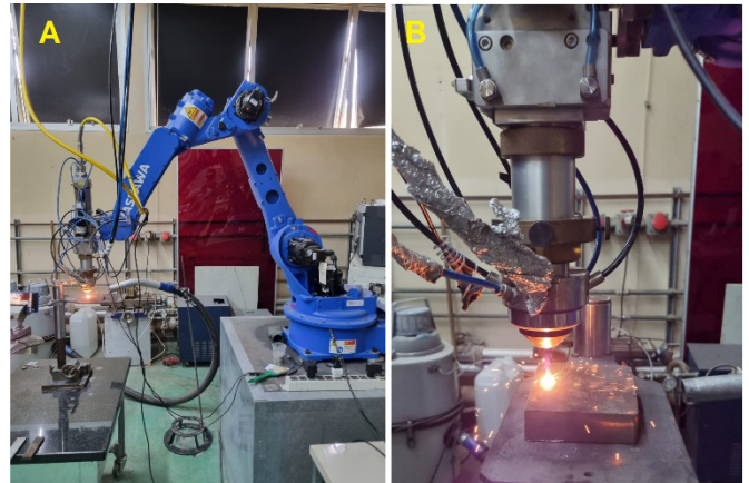
Figura 2 - Visão geral do equipamento de deposição: (A) Braço robótico; e (B) Cabeçote com laser e alimentadores de pó
