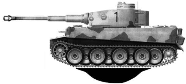
Fig. 5 – Distribuição de pressão senoidal com máxima pressão no centro – Tiger I [14].
