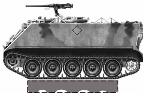
Fig. 1 – Distribuição de pressão uniforme – VBTP M113 [14].
