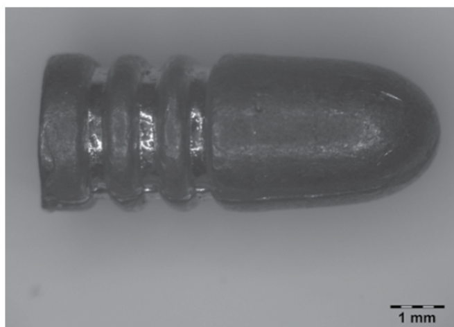
Fig. 1 – Imagem do projétil .22 utilizado no ensaio balístico
