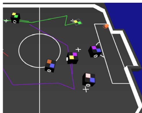
Fig. 9 – Plataforma VSS-Simulator. Existem 2 times de robôs diferenciais, para cada robô controlado são desenhados caminhos.
