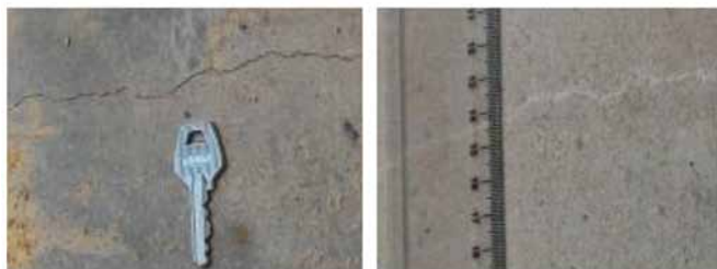
Fig. 7 – Regeneração de trincas 1mm (a) 24 horas e (b) 48 horas após a compactação.
