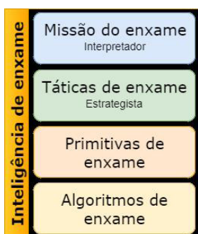
Fig. 5 – Arquitetura em camadas da inteligência de enxame de um robô pertencente a um SARP.
