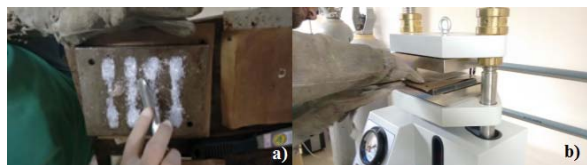
Fig. 3 - Policarbonato sendo depositado no molde (a) e, em seguida colocado na prensa (b).
