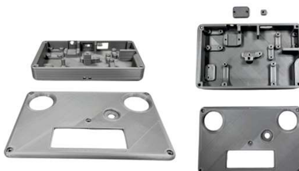
Figura 4 - Protótipo da estrutura física do controle - Elaborado pelos alunos do curso Avançado de Eletrônica
