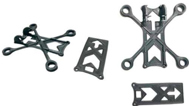
Figura 2 - Protótipo da estrutura física do drone - Elaborado pelos alunos do curso Avançado de Eletrônica
