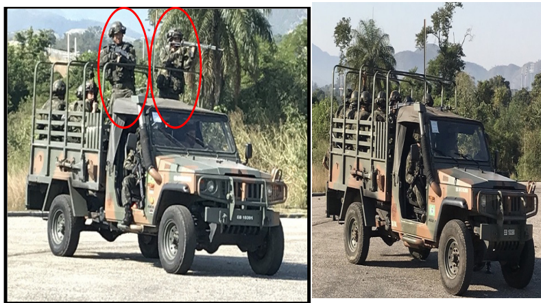
Figura 6 – Alteração na posição de Torre (menor exposição do militar)
