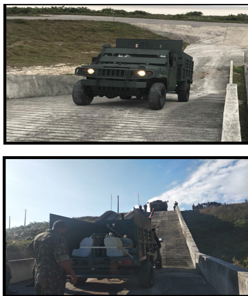
Figura 12 – Testes de desempenho com lastro simulado da blindagem e pessoal realizados no CAEx
