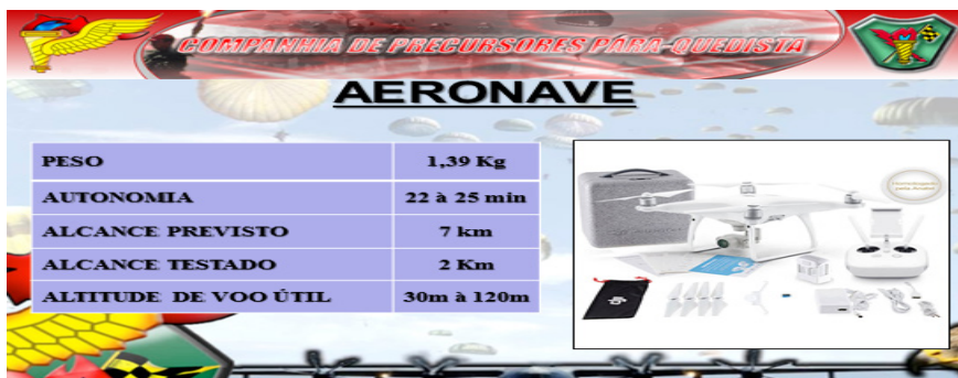
Imagem 3 – Características da ARP Modelo PHANTOM 4 ADVANCED DJI® utilizada pela Cia Prec
