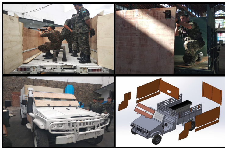
Figura 11 – Estudos para a concepção da proteção blindada das Vtr Marruá (AGR/RJ e CA Leste)
