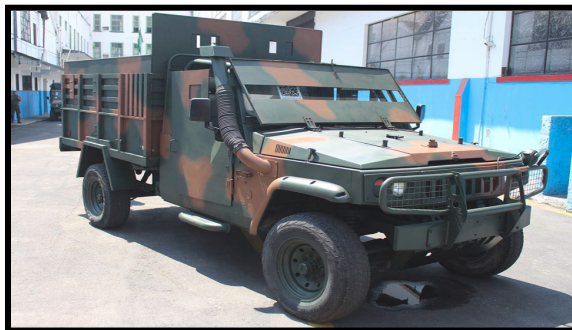
Figura 13 – Vtr Marruá adaptada com blindagem pronta para o emprego
