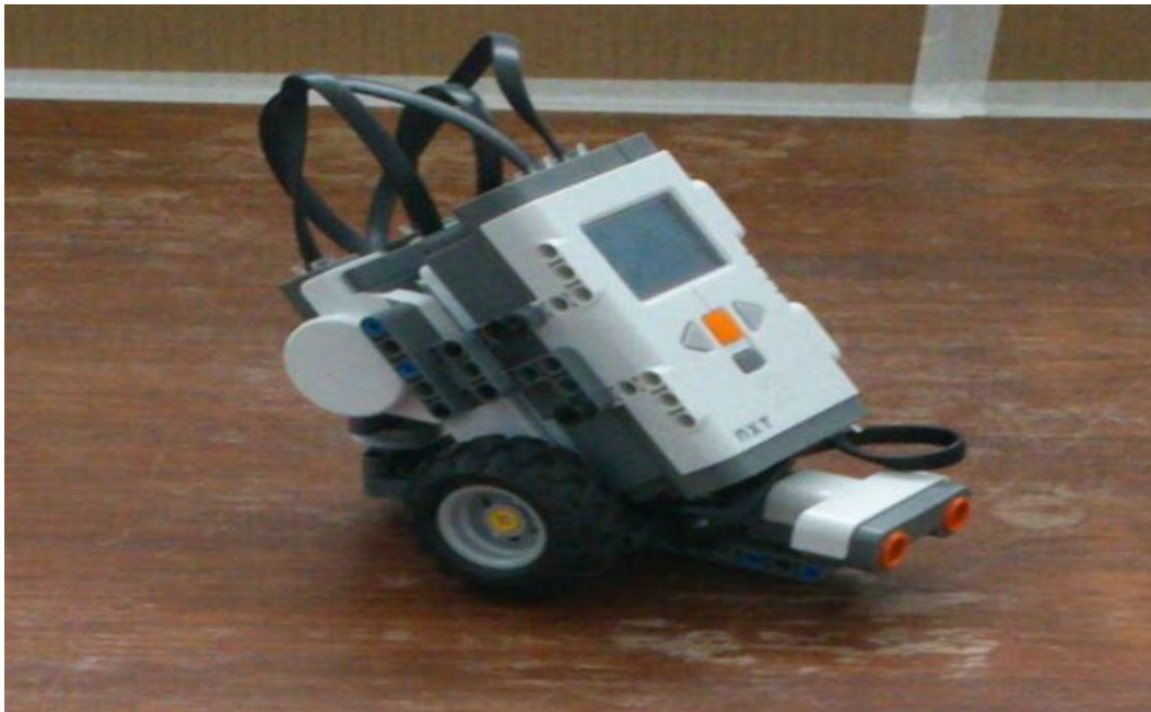
Figura 4 – Robô Localizador. Detalhe para o sensor ultrassônico acoplado na frente Foto do autor
