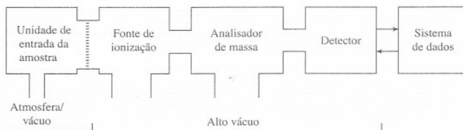
Figura 3 – Espectrômetro de massas de forma estruturada.
