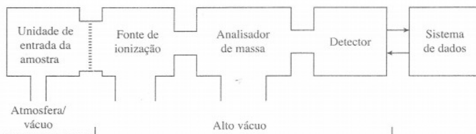
Figura 3 – Espectrômetro de massas de forma estruturada. Fonte: Puc-RIO – Teses abertas (2018)
