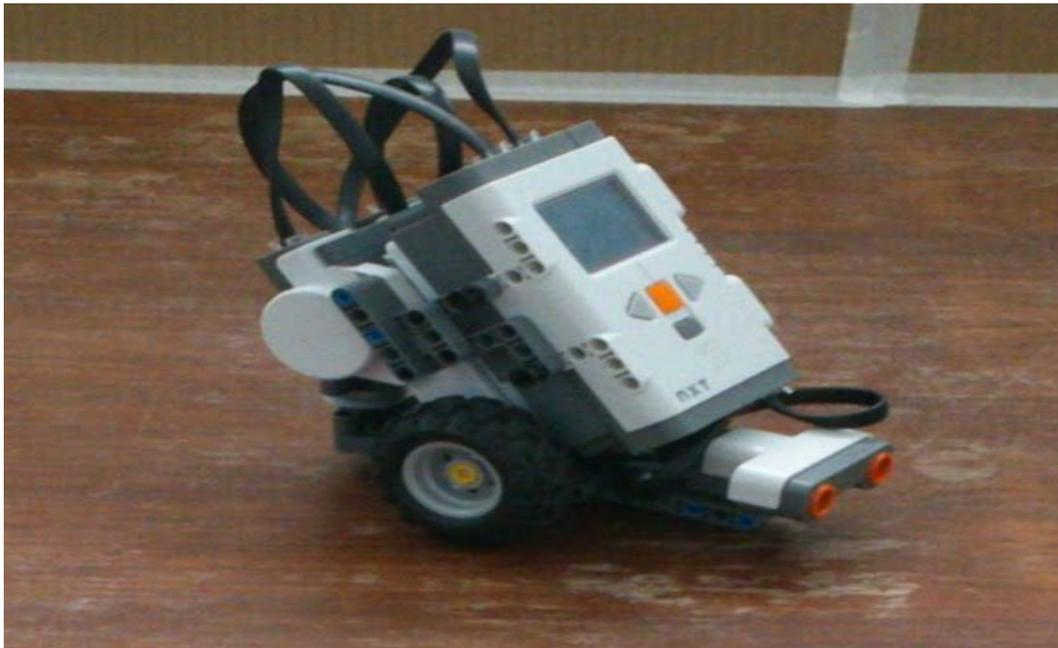
*Figura 4 – Robô Localizador. Detalhe para o sensor ultrassônico acoplado na frente
