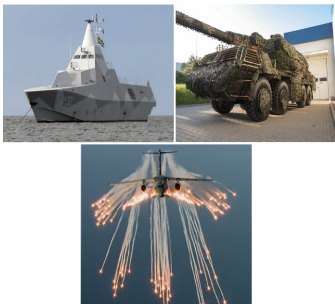
Fig. 10 -Estrutura geométrica para espalhar sinais de rádio de mísseis (esquerda). Blindado com rede de camuflagem absorvedora de radiação (direita). KC-390 com emissão de flare e chaff (abaixo)
