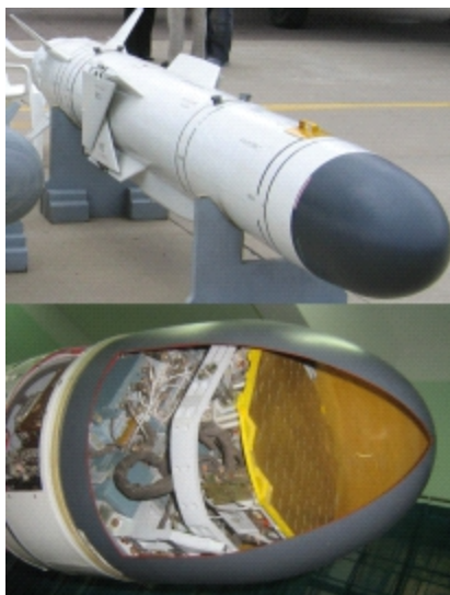
Fig. 3 - Míssil russo Zvezda Kh-35, equipado com um Seeker radar ativo
