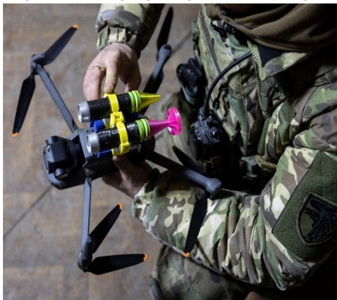
Fig. 3 - DJI Mavic 3, adaptado para transportar e lançar munições explosivas
