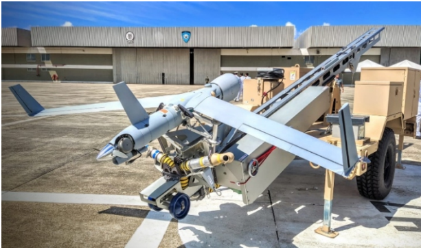
Fig. 6 - ScanEagle – Origem: EUA (Boing Insitu) – SARP Categoria 3 – Operado pelo 1º Esquadrão de Aeronaves Remotamente Pilotadas (EsqdQE-1) sediado em São Pedro da Aldeia-RJ
